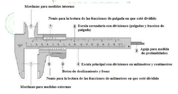
Una de las características que tienen los instrumentos de medición es la *apreciación*, que es la medida más pequeña que es perceptible en un instrumento de medida, y se puede calcular mediante la fórmula:
