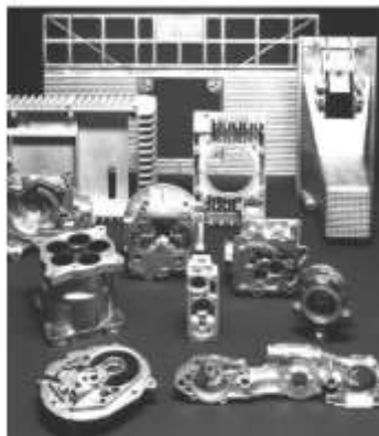
FIGURA 2 Algunos ejemplos de piezas obtenidas por fundición
