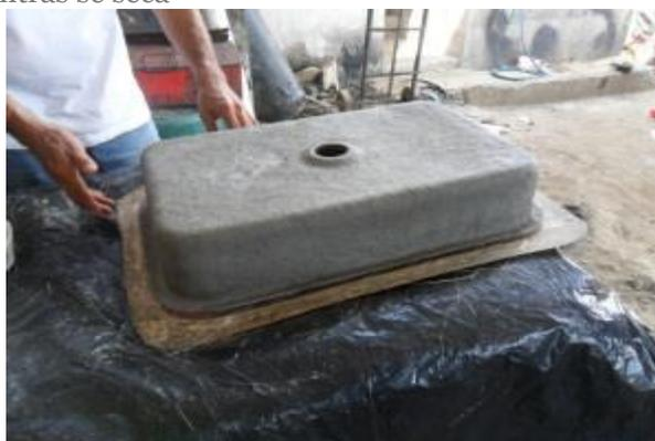
Desmoldar, con la pieza ya fundida y lista para desmoldar, se toma un martillo y un destornillador para sacarla.
