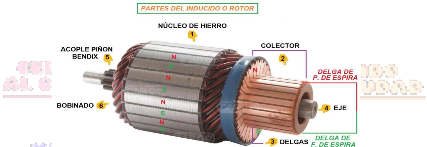
Imagen 4. Partes del rotor o inducido
